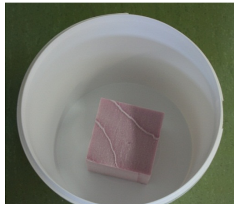
Bilde 4: Plassering av isolasjonsblokker i testbøtter.
